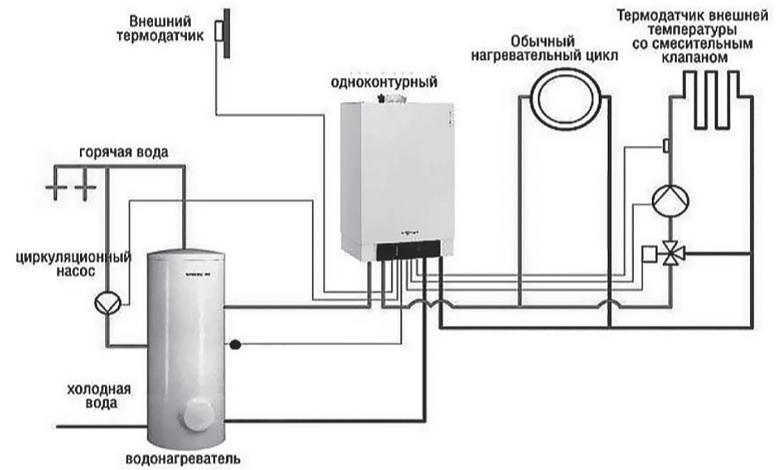
рудования – двухконтурная модель стоит дешевле, чем одноконтурный котел и дополнительный водонагреватель; компактные габариты; возможность эксплуатации устройства в любое время года – летом котел можно использовать для снабжения горячей водой, не задействуя контур отопления; более низкие затраты на энергоресурсы.
