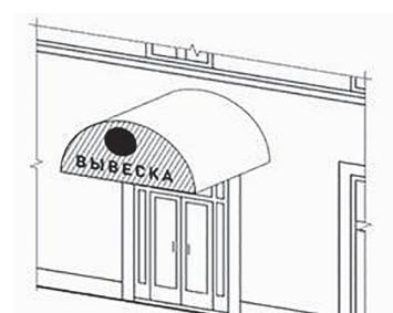
Рисунок 6. При наличии на фасаде объекта козырька настенная конструкция может быть размещена на фризе козырька. Запрещается размещение настенной конструкции непосредственно на конструкции козырька.
